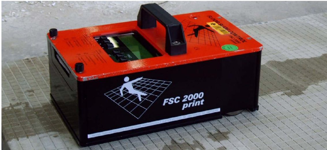
De FSC 2000 print is een handzaam apparaat om op locatie wrijvingsweerstand te meten.
